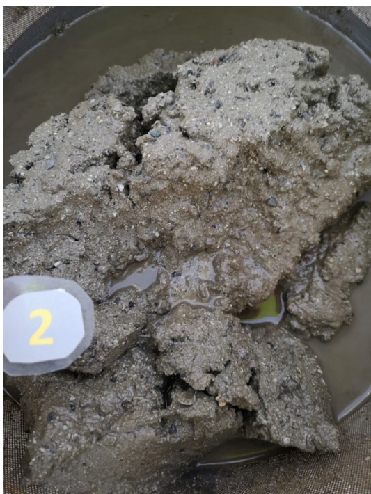
Figur A-2: Bilde av sedimentet ved C2. Sedimentet besto av silt, sand, skjellsand og grus. Prøven hadde en pelittandel på 46,4% (se Kjemianalyser rapport i Vedlegg C ). Foto: Aqua Kompetanse AS.
