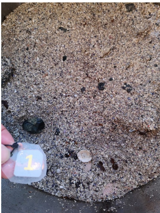
Figur A-1: Bilde av sedimentet ved C1. Sedimentet besto av grov skjellsand og stein. Prøven hadde en pelittandel på 20,4% (se Kjemianalyser rapport i Vedlegg C ). Foto: Aqua Kompetanse AS.
