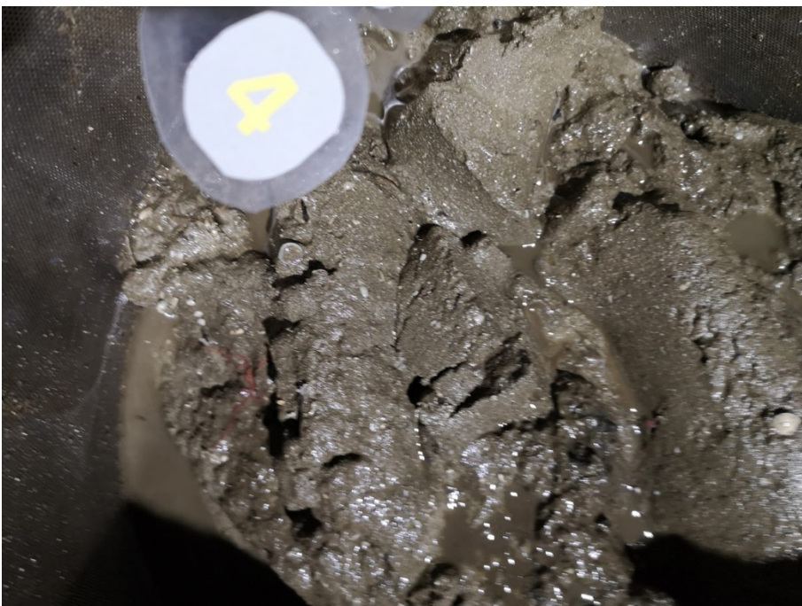
Figur A-4: Bilde av sedimentet ved C4. Sedimentet besto av silt og skjellsand. Prøven hadde en pelittandel på 64,1% (se Kjemianalyser rapport i Vedlegg C)]. Foto: Aqua Kompetanse AS.
